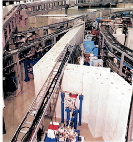
Visão parcial do anel de armazenamento de elétrons do LNLS com instrumentação que leva luz síncrotron até estações experimentais
