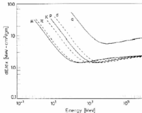
Figura : Dependencia de  $dE/dx$  como una función de la energía cinética para diferentes partículas.
