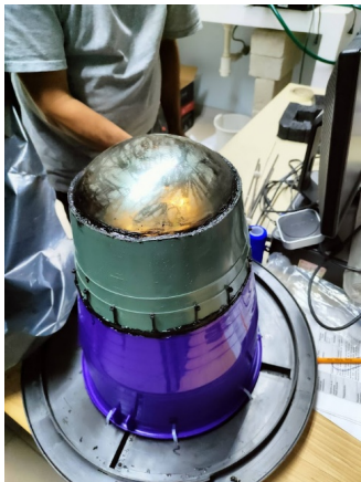
Imagen 4. Acondicionamiento del PMT para introducirlo al tanque.
