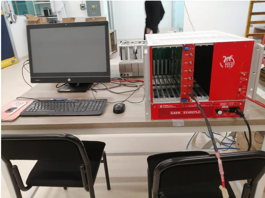
Fuente de alto voltaje usada para alimentar las cámaras de gas
