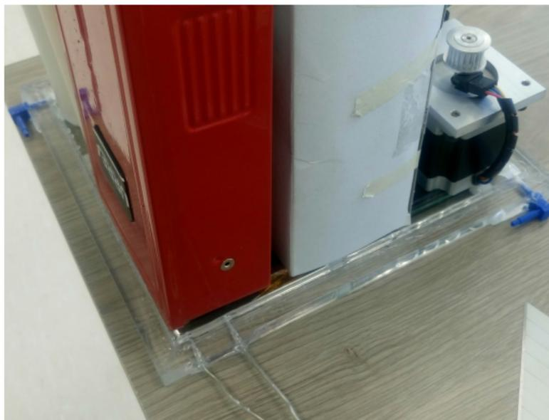
Figura 13: Detector sellado con la mezcla de resina.
