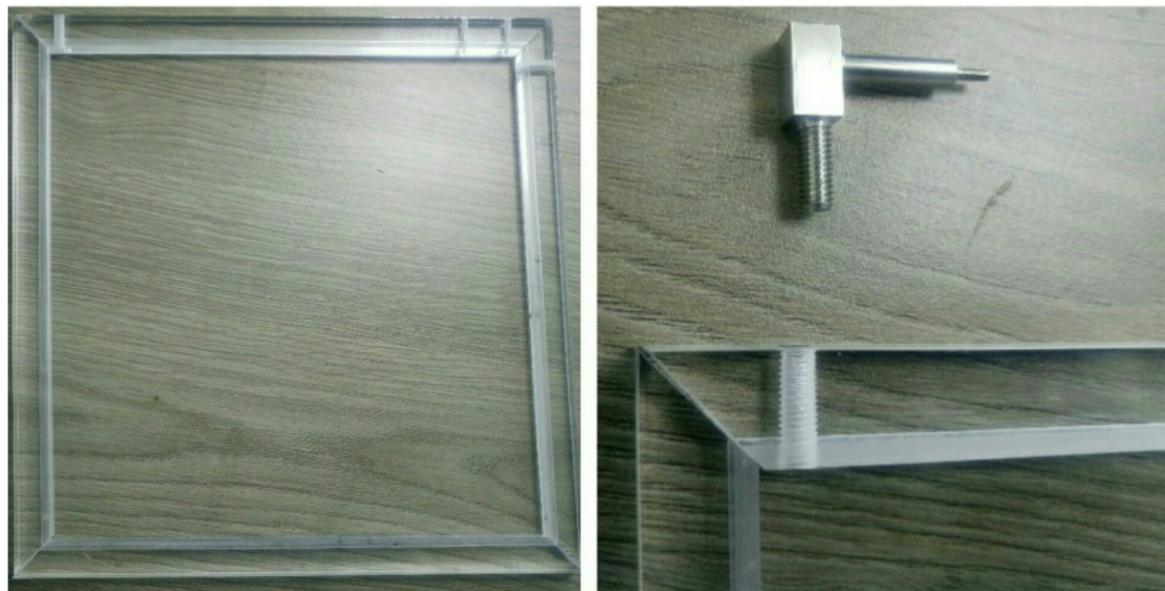
**Figura 9:** Marco de acrílico de  $25 \times 25 \times 1$  cm. (izquierda) y conectores para la entrada y salida del gas (derecha).
