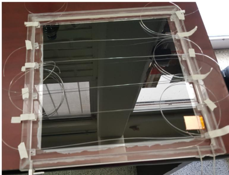
Figura 11: Fotografía que muestra la colocación de los monofilamentos de nylon.
